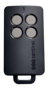
Portée 50 m en champ libre Sécurité avec code secret tournant Fréquence : 433.05 MHz à 434.79 MHz Puissance maximale d'émission : <10mW Alimentation: 3V DC
