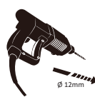
Perforateur + foret béton 12mm
