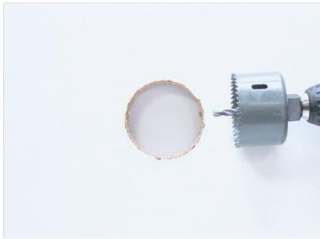
Percer un trou à l'aide d'une scie cloche
