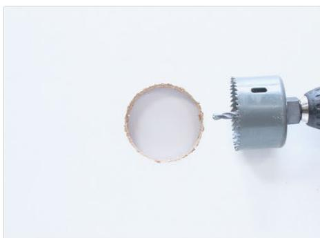
Percer un trou à l'aide d'une scie cloche  $\varnothing 67$
