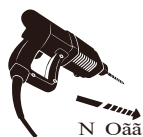
Perforateur + foret béton 12mm
