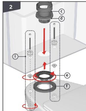
**FR** FIXATION DU CULOT : Placer et au fond du réservoir. Serrer l'écrou à l'aide de l'outil fourni. Centrer sur la cuvette. Fixer le réservoir avec les visseries .
