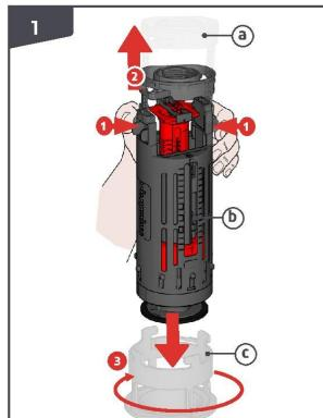
**FR** DÉCLIPSAGE DE L'ÉTRIER en appuyant fortement avec le pouce et l'index et du culot en tournant d'un 1/4 de tour.
