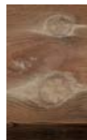
Round knots/Nudos redondos/Noeuds ronds/ Runde knoten/Nodi rotondi/Ronde kwasten/ Nós redondos
